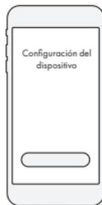
Siga las instrucciones que aparecen en la pantalla. El primer paso será registrar un ajuste de nivel de flujo cero para el dispositivo. Deberá dejar el dispositivo en una superficie plana para completar este proceso.
